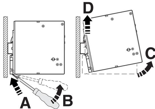
Bild 9 Abheben der Stromversorgung von der Tragschiene
