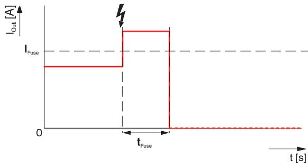
Bild 22 FUSE MODE Ausgangskennlinie
