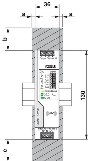
Bild 6 Geräteabmessungen und minimale Sperrflächen (Maße in mm)
