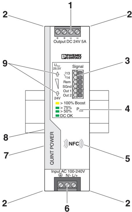
Bild 3 Bedien- und Anzeigeelemente
