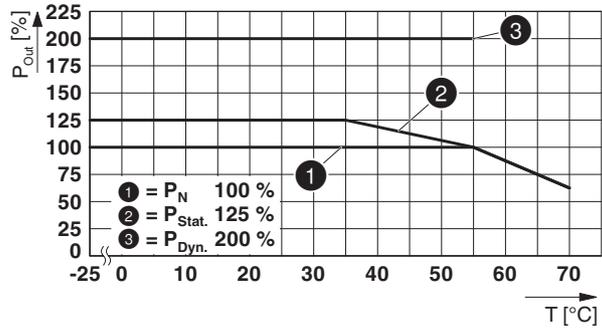
16.4.4 Einbaulage gedreht 270° Z-Achse
