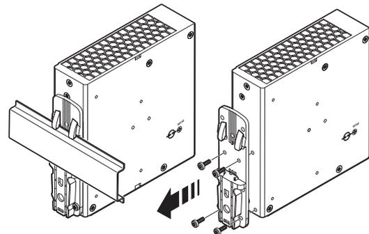
Bild 10 Universal-Tragschienenadapter demontieren
