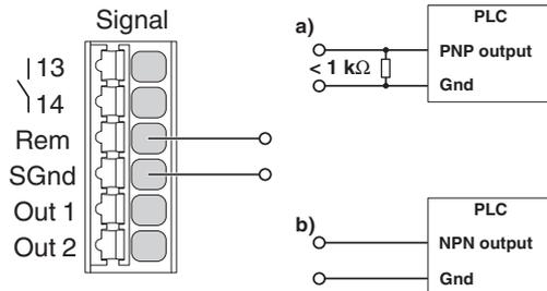
Bild 38 Externe Beschaltungsvarianten bei PNP- und NPN-Ausgang
