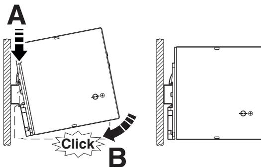
Bild 8 Aufrasten der Stromversorgung auf die Tragschiene
