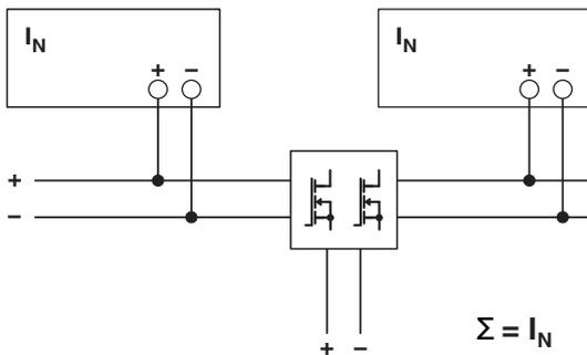
Bild 46 Prinzipdarstellung, Redundanzbetrieb mit QUINT ORING
