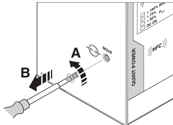
Bild 2 Gasableiter dekontaktieren
