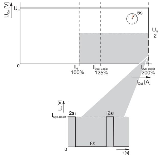
Bild 21 Smart HICCUP Ausgangskennlinie
