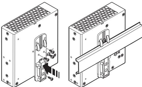
Bild 11 Universal-Tragschienenadapter montieren
