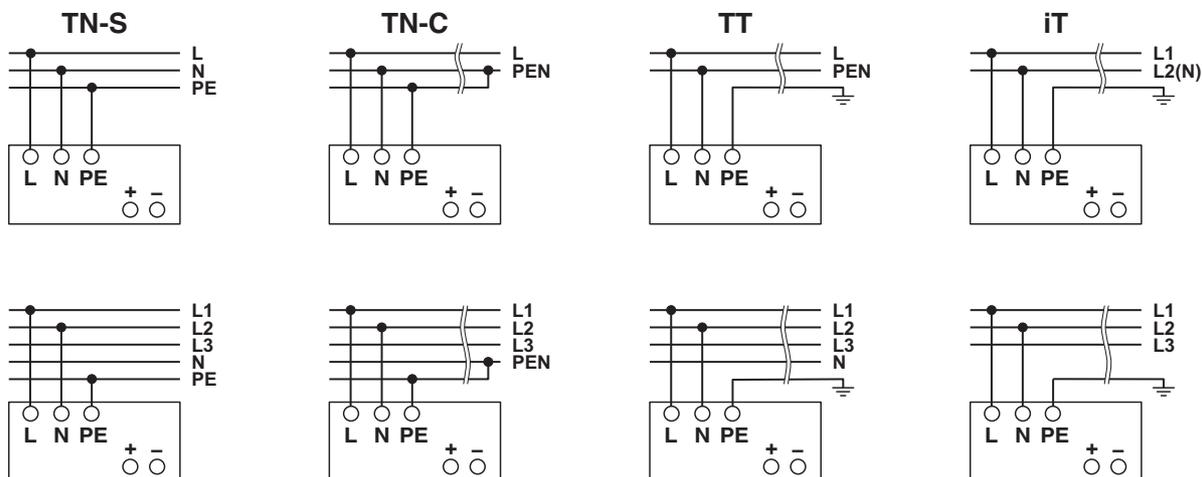
Le raccordement pour 100 V AC ... 240 V AC s'effectue via les connexions vissées L, N et PE.
