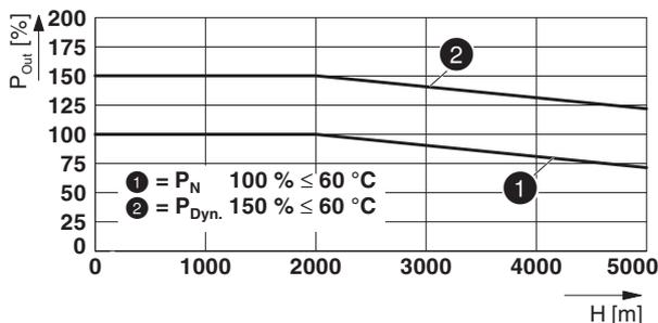
Bild 20 Ausgangsleistung in Abhängigkeit zur Aufstellhöhe
