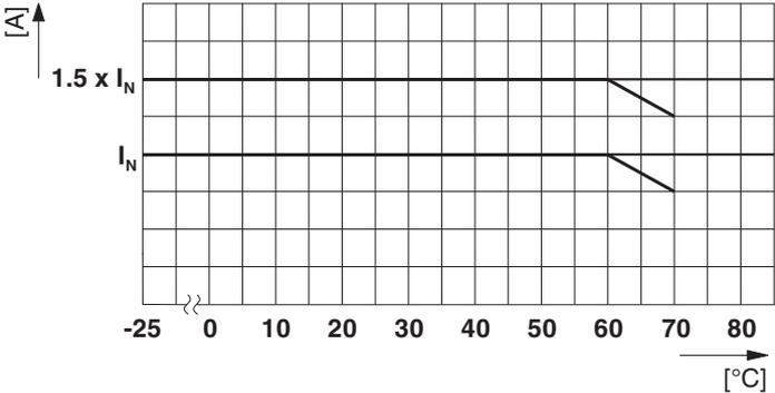
Einbaulage gedreht 90° X-Achse
