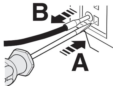
Bild 10 Anschlussleitung lösen (Push-in-Anschluss-Technik)
