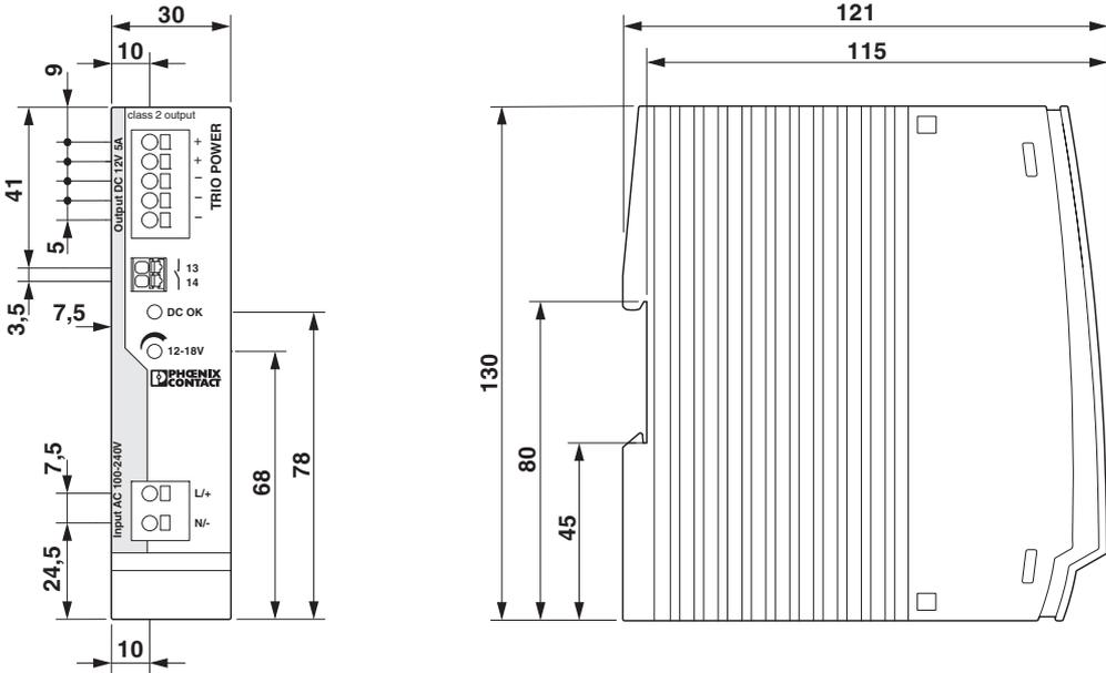
Bild 6 Geräteabmessungen
