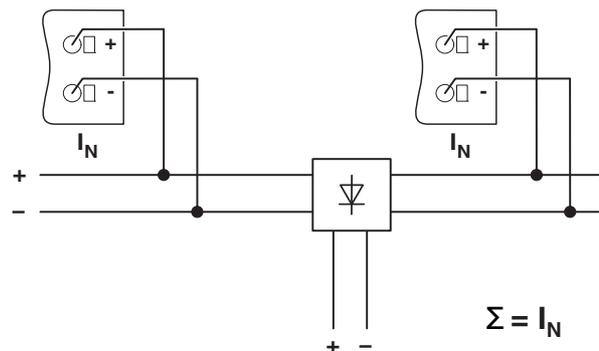
Bild 23 Prinzipdarstellung, Entkoppelung mit Dioden-Modul
