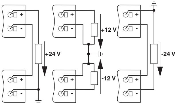
Bild 21 Prinzipbeschaltung, Spannungsebenen mit zwei Stromversorgungen
