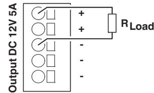
Bild 15 Prinzipdarstellung, Beschaltung der Ausgangsklemmen
