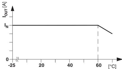
Bild 19 Temperatur-Derating in Normaleinbaulage
