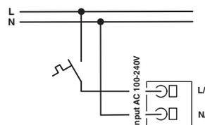
Bild 13 Prinzipdarstellung, Beschaltung der Eingangsklemmen
