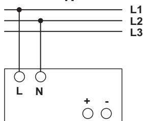
Pour le raccordement 100 V AC à 240 V AC, on utilise les connexions vissées L et N.
