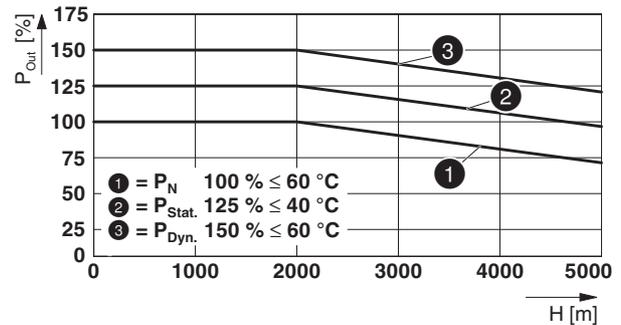
Рисунок 35 Выходная мощность в зависимости от высоты монтажа
