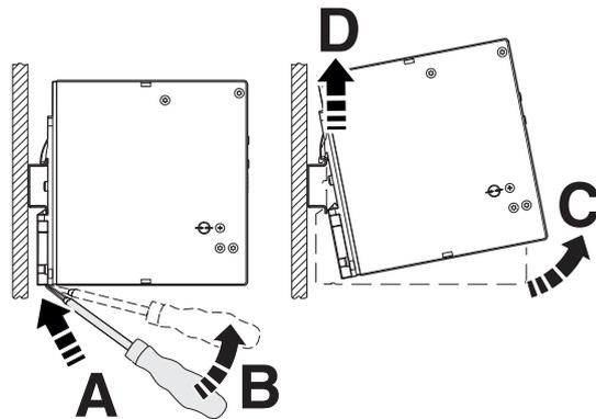
Рисунок 8 Съем источника питания с несущей рейки
