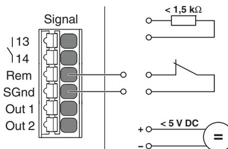
Рисунок 19 Варианты подключения SLEEP MODE
