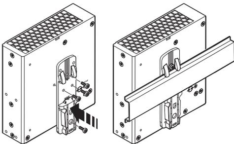
Рисунок 10 Установка универсального адаптера для монтажной рейки
