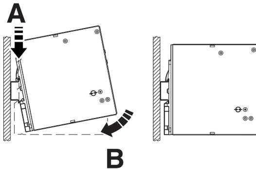
Рисунок 7 Крепление источника питания на несущей рейке
