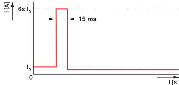
Рисунок 21 Импульс SFB инициирует срабатывание защитного автомата
