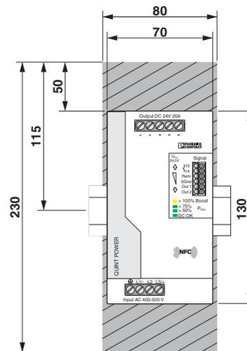
Рисунок 4 Размеры устройства и максимальные закрытые поверхности (мм)
