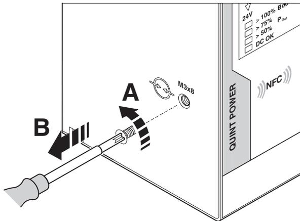
Рисунок 2 Отсоединить газоразрядник
