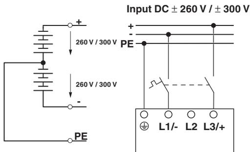
Рисунок 15 Расположение контактов при питании постоянным током
