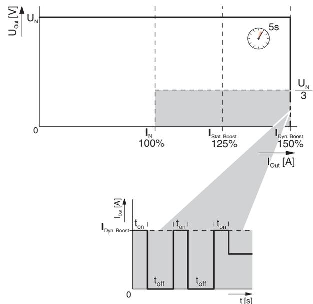
Рисунок 16 Расширенная вольт-амперная выходная характеристика
