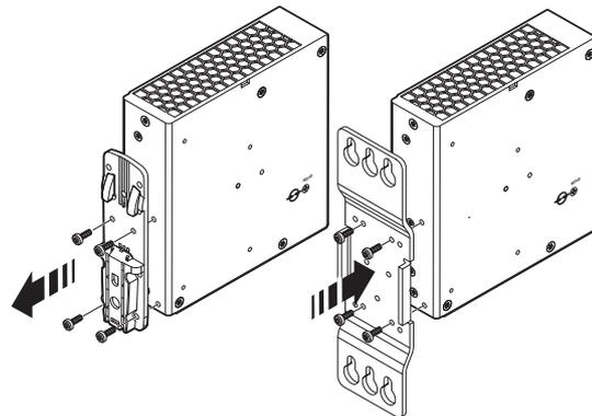
Рисунок 11 Установка универсального настенного адаптера UWA 182/52
