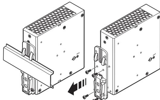
Рисунок 9 Демонтаж универсального адаптера для несущей рейки
