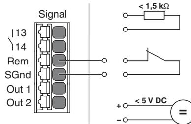
Рисунок 24 Варианты внешних схем включения, включение SLEEP MODE
