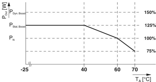
Рисунок 33 Выходная мощность в зависимости от окружающей температуры
