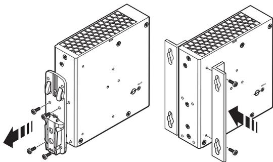
Рисунок 12 Установка универсального настенного адаптера UWA 130
