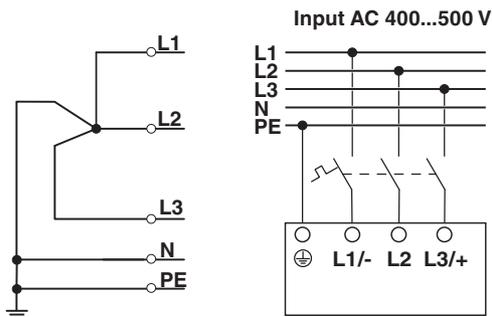
Рисунок 14 Расположение контактов при питании переменным током
