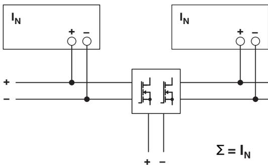
Рисунок 31 Принципиальная схема, резервный режим через QUINT ORING
