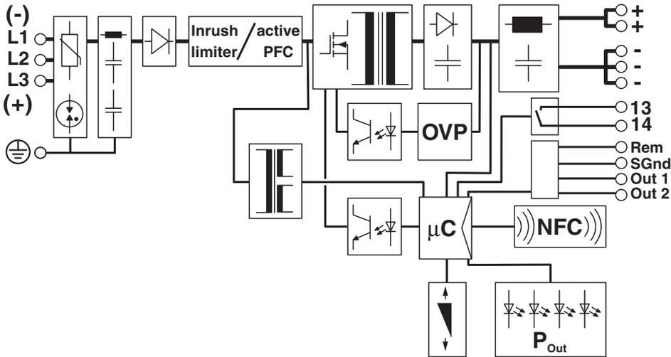
Рисунок 6 Блок-схема
