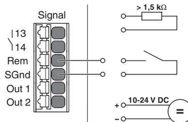
Рисунок 25 Варианты внешних схем включения, выключение SLEEP MODE
