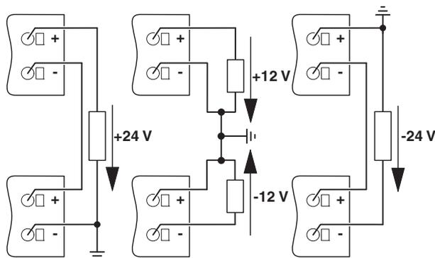
Рисунок 21 Принципиальная схема, уровни напряжения с двумя источниками питания
