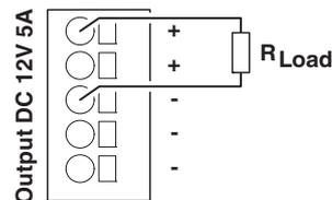
Рисунок 15 Принципиальная схема, подключение выходных клемм
