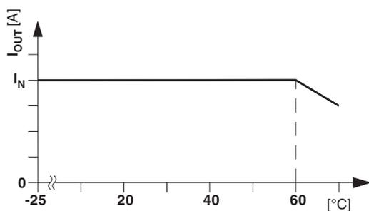
Рисунок 19 Кривая температуры при нормальном положении встраивания
