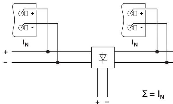
Рисунок 23 Принципиальная схема, развязка через диодный модуль
