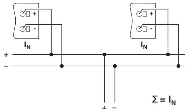
Рисунок 22 Принципиальная схема параллельного режима работы
