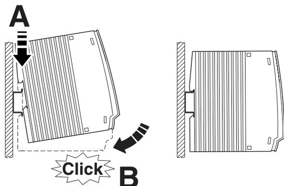
Рисунок 7 Установка на стандартную рейку
