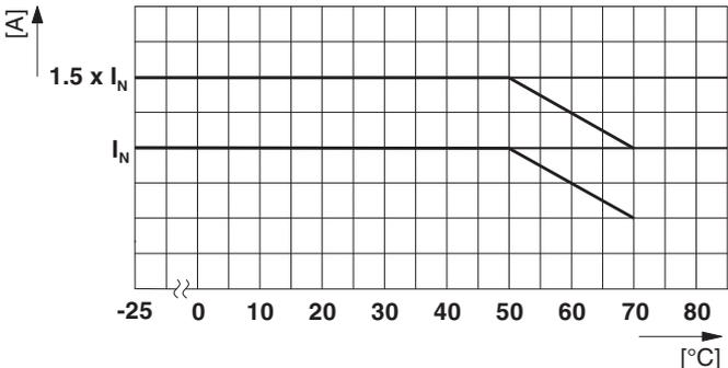
Монтажное положение с поворотом на 90° по оси Z
