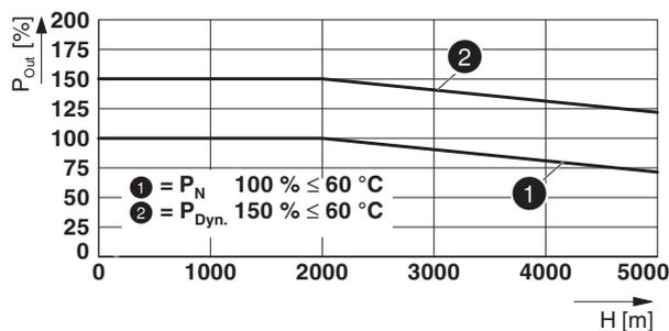
Рисунок 20 Выходная мощность в зависимости от высоты монтажа
