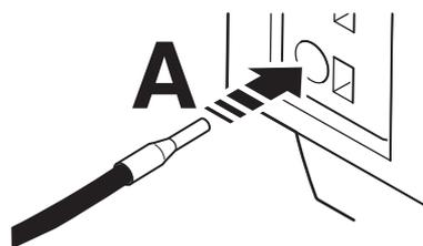
Рисунок 9 Вставить соединительный кабель (технология подключения Push-In)
