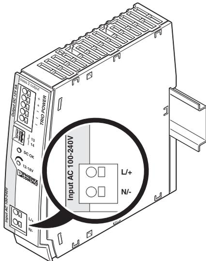
Рисунок 12 Положение входных клемм
