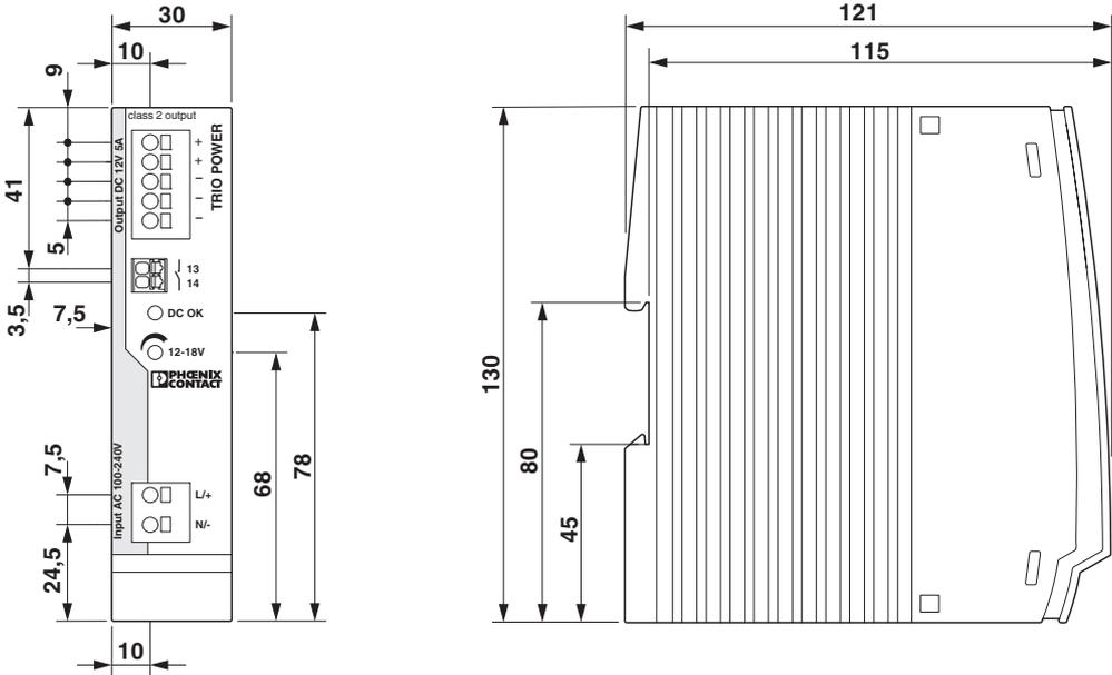
Рисунок 6 Размеры устройства
