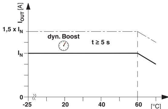
Рисунок 19 Кривая температуры при нормальном положении встраивания
