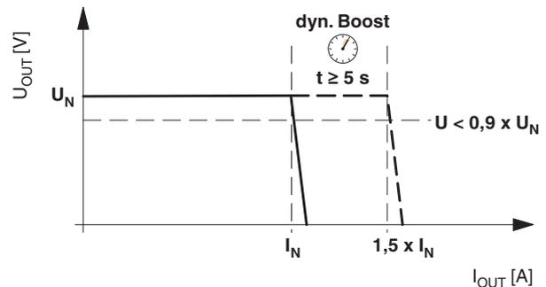
Рисунок 15 Вольтамперная характеристика с динамическим резервом нагрузки
