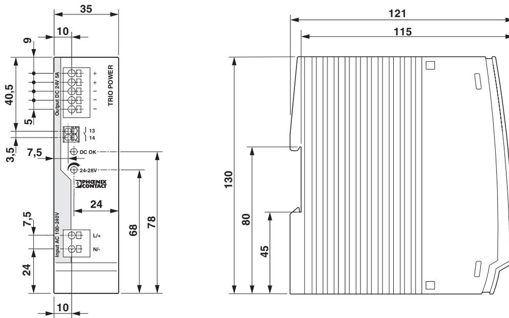
Рисунок 5 Размеры устройства
