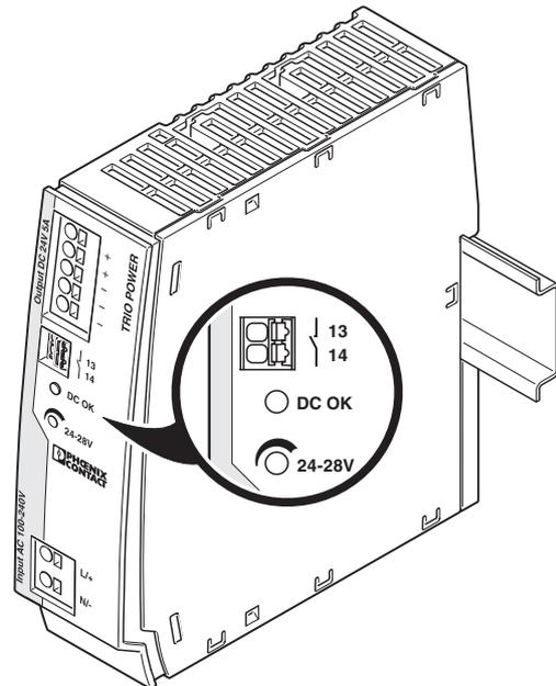
Рисунок 17 Положение элементов
