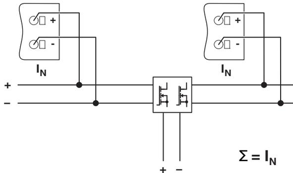
Рисунок 23 Принципиальная схема, развязка через модуль ORING
