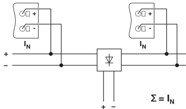
Рисунок 22 Принципиальная схема, развязка через диодный модуль
