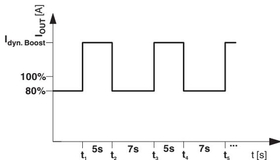
Рисунок 16 Принципиальная схема поведения динамического резерва мощности
