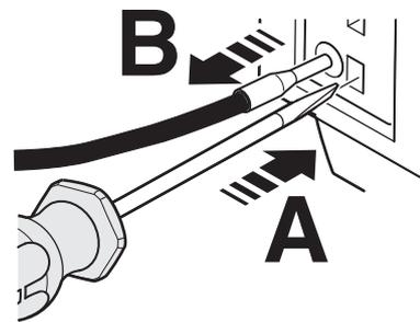
Рисунок 9 Отсоединить кабель (технология подключения Push-In)
