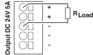
Рисунок 14 Принципиальная схема, подключение выходных клемм
