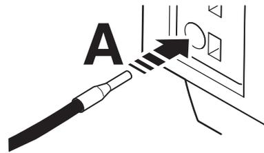
Рисунок 8 Вставить соединительный кабель (технология подключения Push-In)
