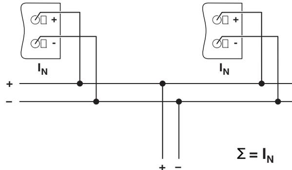
Рисунок 21 Принципиальная схема параллельного режима работы
