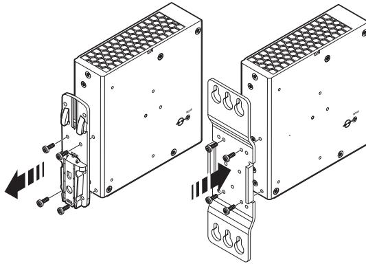
图 11 安装 UWA 182/52 通用型壁挂式适配器
