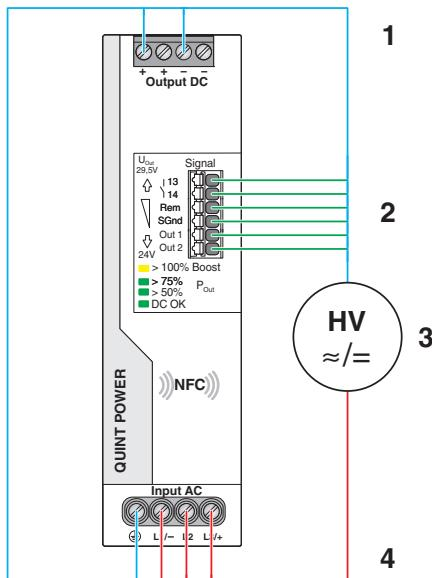
图 1 用于高电压测试的电势相关接线
