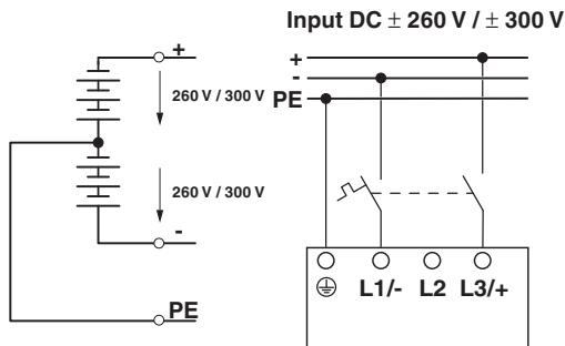
图 15 DC 电源电压的引脚分配
