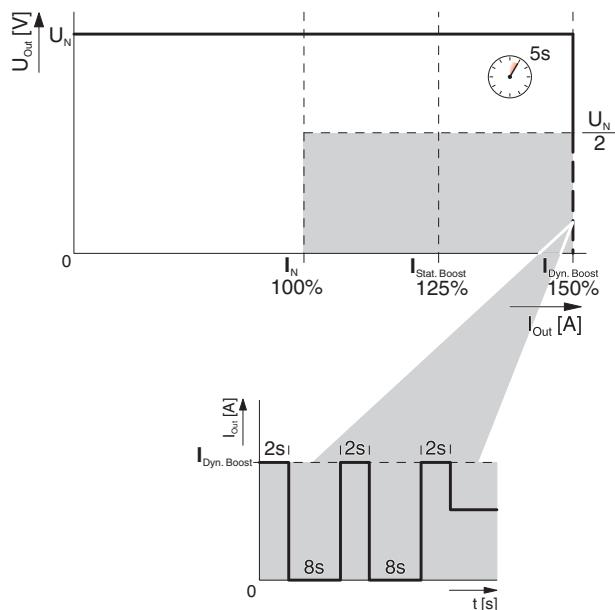
图 17 Smart HICCUP 输出特性曲线
