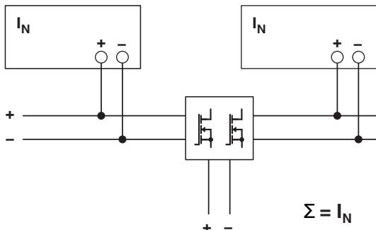
图 31 示意图, 使用 QUINT ORING 的冗余运行
