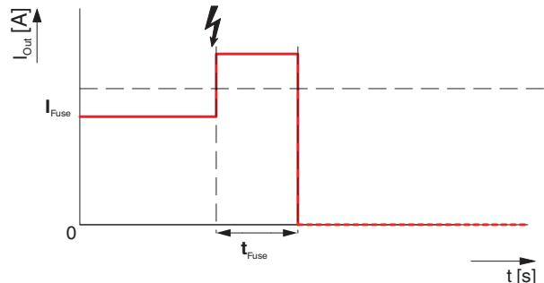
图 18 FUSE MODE 输出特性曲线
