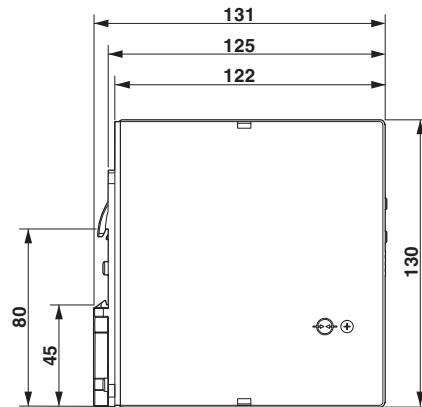
图 5 设备尺寸 (单位 mm)
