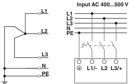
图 14 AC 电源电压的引脚分配
