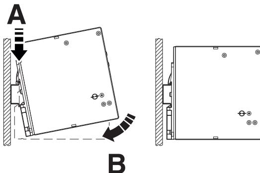
图 7 将电源卡接到 DIN 导轨上
