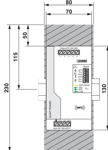
图 4 设备尺寸和最大禁入区域 (单位 mm)
