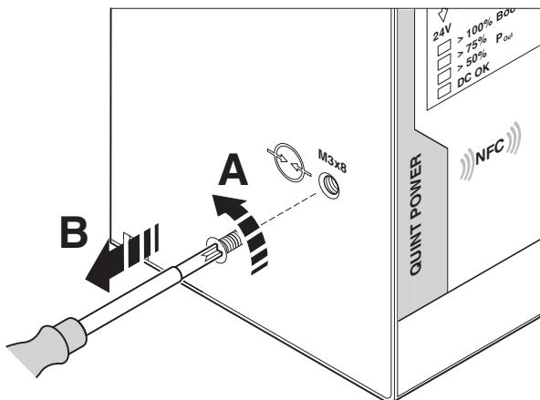
图 2 断开气体放电管的连接
