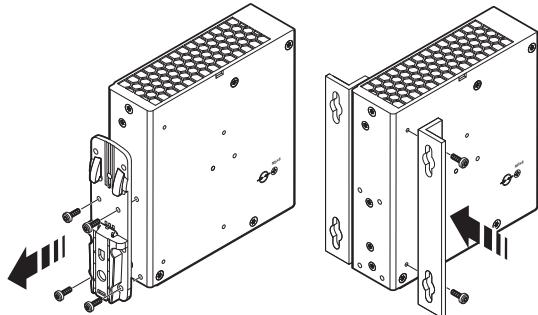
图 12 安装 UWA 130 通用型壁挂式适配器
