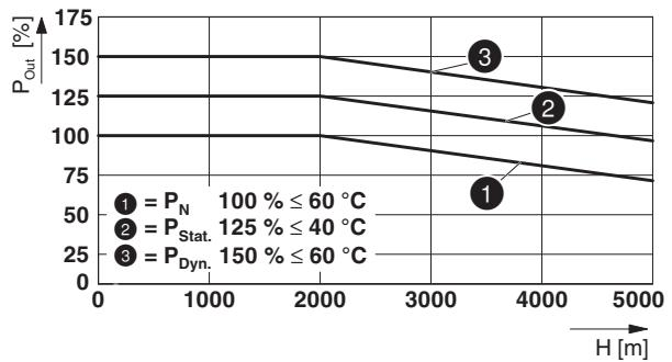
图 35 输出功率取决于安装高度
